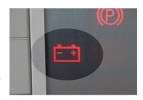
•Ist die Lichtmaschine defekt, kann mit dem vorhandenen Strom aus der Batterie weitergefahren werden. Alle unnötigen Stromverbraucher abschalten
