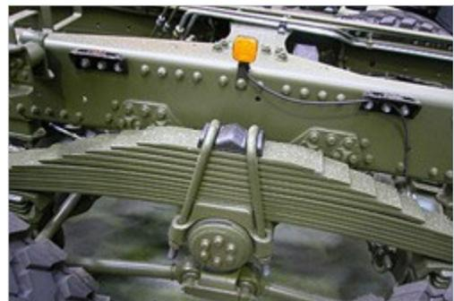
"Federbriden" verbinden das Federpaket mit der Achsplatte.
